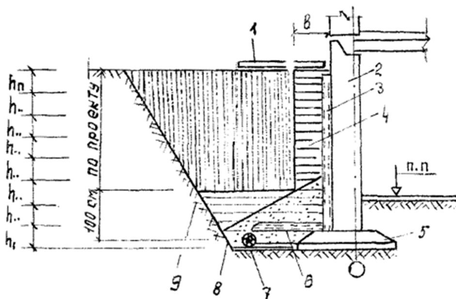
Рис. 3.1. Схема обратной засыпки пазухи котлована:
