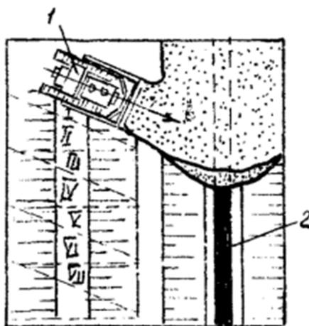
Рис. 4.4. Обратная засыпка траншей грунтом при помощи бульдозера:
